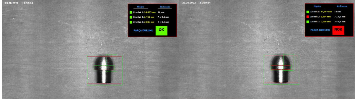
Şekil 6. İkinci tip örnek parça hata tespiti
