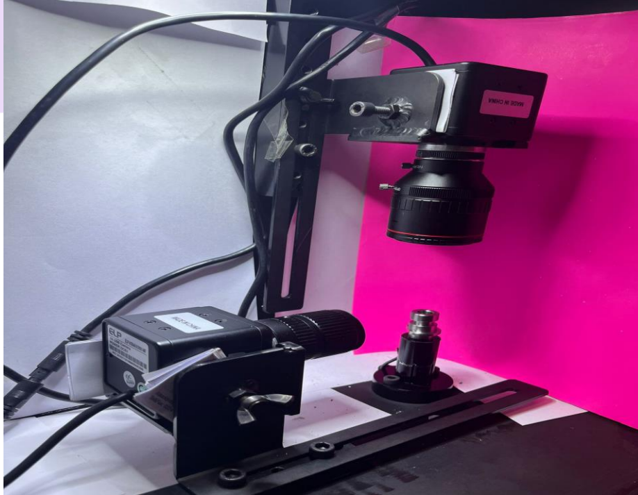
Şekil 2. Geliştirilen yapay görme sistemi test kabini
