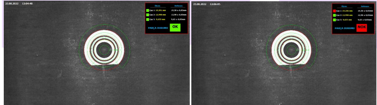
Şekil 7. İkinci tip (alt görünüm) örnek parça hata tespiti
